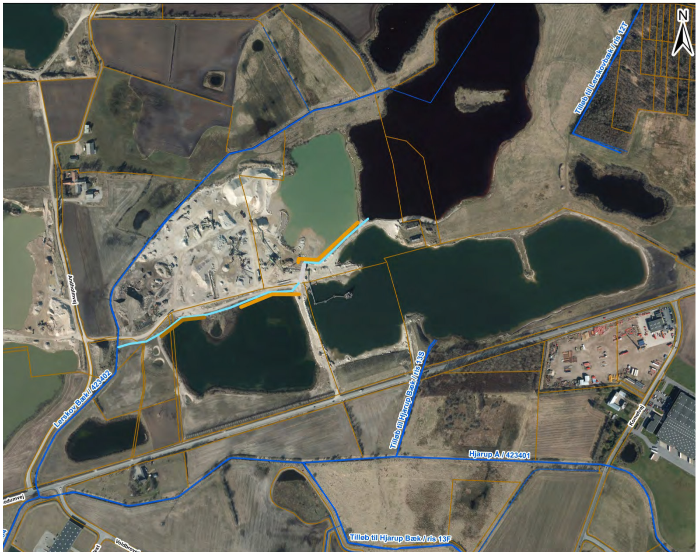
Figur 1: Oversigtskort over området. Den lyseblå streg indikerer Lerskov Bæks nye forløb. Dæmninger er angivet med lys brun og rørlægningen med lys grå
