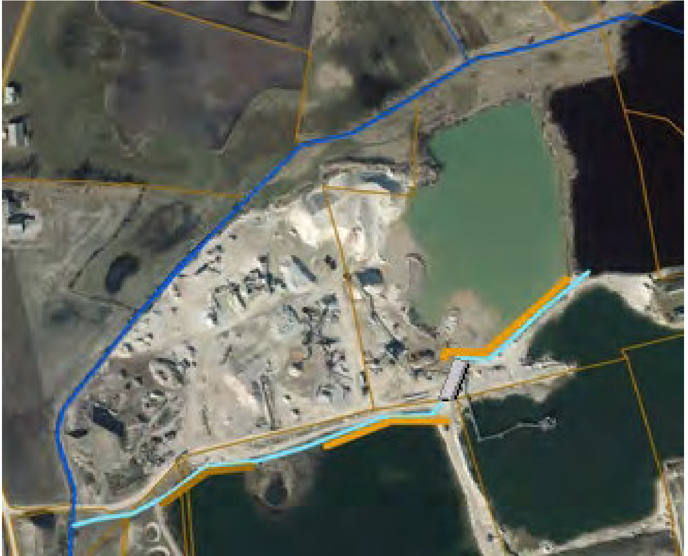
Figur 2: Udsnit af oversigtskortet. Den lyseblå streg indikerer Lerskov Bæks nye forløb. Dæmninger er angivet med lys brun og rørlægningen med lys grå
